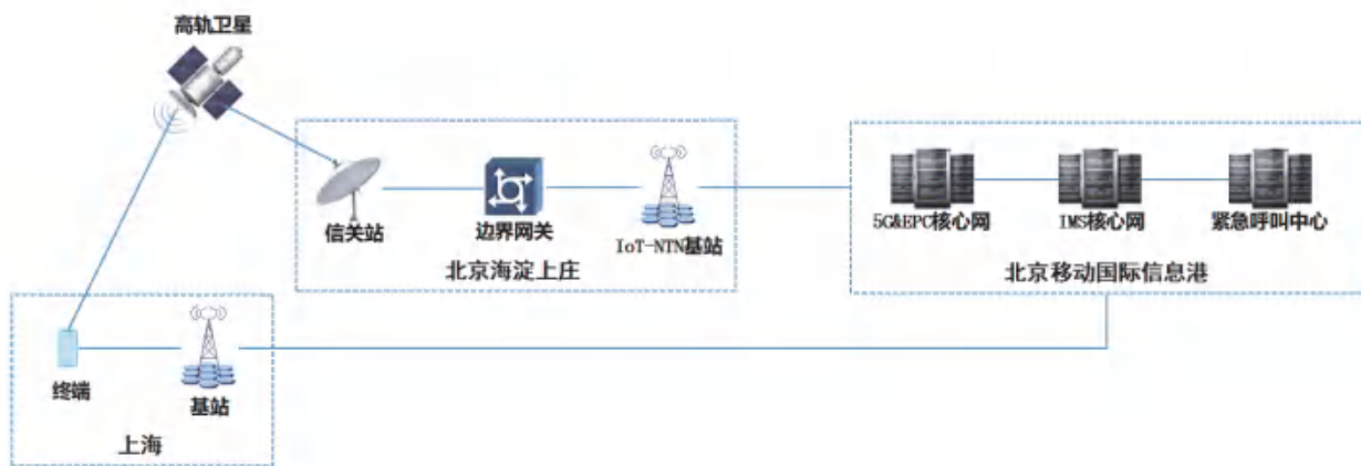
图2. 手机直连高轨卫星NB-IoT NTN语音功能验证组网架构
